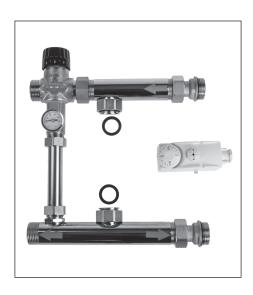
Компактные смесительные узлы используют для регулирования расхода и температуры теплоносителя, подаваемого в систему гидравлического напольного отопления. Конструкция смесительного узла позволяет монтировать его как с левой, так и с правой стороны распределительного коллектора.
